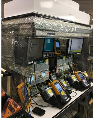
Figura 2: Estación de calibración de fibra. Observe el plástico que rodea la estación en el sistema de filtrado en la parte superior para reducir el polvo. Fluke Networks modifica algunos de los productos disponibles comercialmente para que cumplan nuestros requisitos de precisión.
