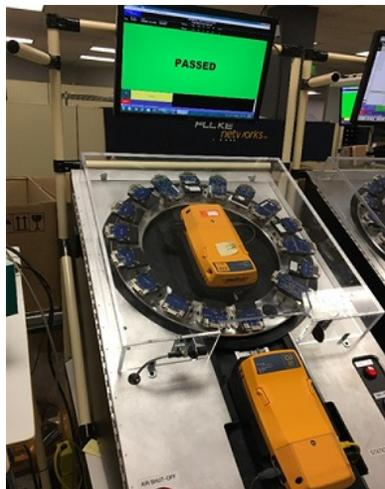
Figura 1: Estación de calibración de cobre. Diecisiete artefactos de diseño hechos a la medida están conectados en secuencia a la unidad Versiv para
