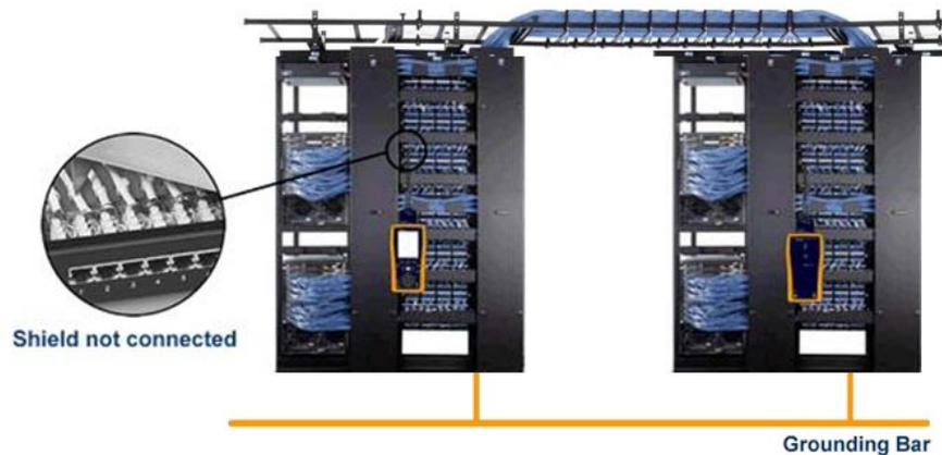
Figura 1: ruta del blindaje a través de la conexión a tierra del edificio
