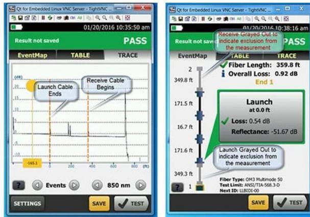
Figura 6. El seguimiento incluye las fibras de lanzamiento y recepción al principio y al final del enlace bajo comprobación. El EventMap que se muestra a la derecha usa la compensación de lanzamiento para eliminar sus efectos de los resultados de comprobación.
