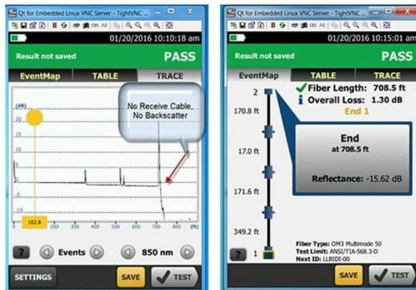
Figura 4. Sin un cable de recepción o de "cola", no se puede observar el rendimiento del último conector.
