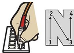
Figura 8: “De húmedo a seco”: Metodología de limpieza usando una tarjeta de limpieza óptica de Fluke Networks. 1a gota de disolvente se coloca en “1” y la terminación se mueve a través del material de limpieza de “1” a “4”
